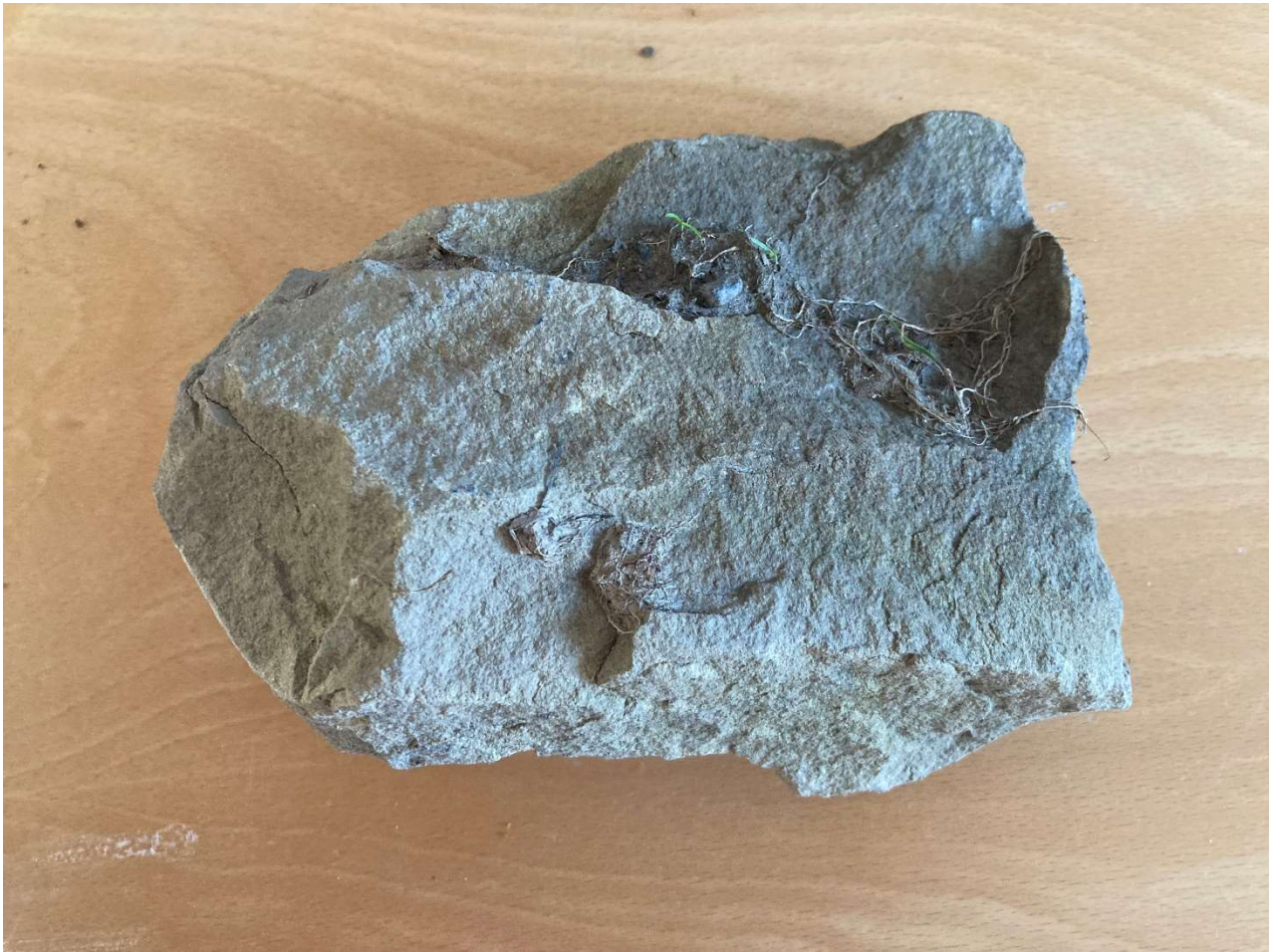
Abbildung 3: feinsandiges Dolomitgestein aus dem Unteren Muschelkalk (Muschelsandstein)
