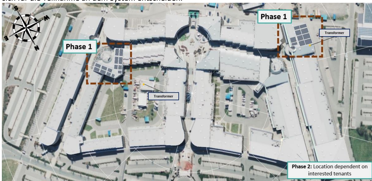
Abbildung 11: 150 kWp (Phase 1) nach Süden ausgerichtete PV-Anlagen auf dem bestehenden Dach
